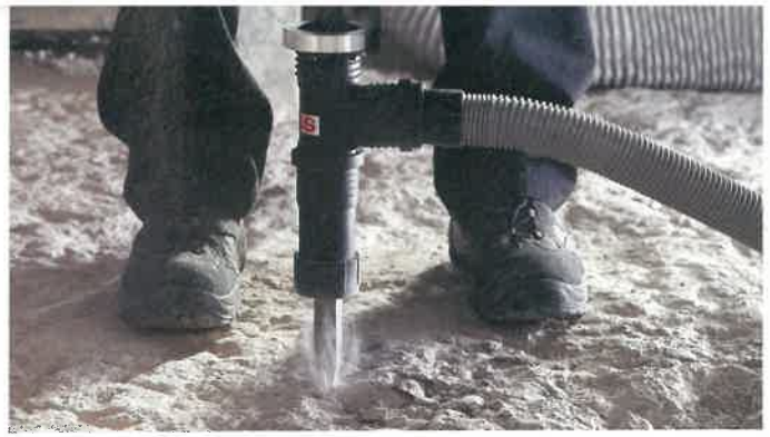
Besonders bei Meißel- und Abbrucharbeiten entsteht viel Staub. Damit er dort abgesaugt wird, wo er entsteht, hat Duss die Staubabsaugsysteme „Mash“ und „Masp“ entwickelt, die mit einem angeschlossenen Industriesauger für ein staubfreies Arbeiten sorgen. Mit der Längenverstellung für unterschiedliche Meißellängen und einem schwenkbaren Gehäuse sind die Staubabsaugungen „für jeden Anwendungsfall“ geeignet. Sie sind für alle Duss-Meißel- und Abbruchhämmer sowie Kombihämmer ab der 4-kg-Klasse einsetzbar. Bild: Duss
